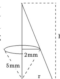
Durch Einsetzen der so erhaltenen *Nebenbedingung* für  $r$  und  $h$  in die Volumenformel  $V = \frac{1}{3} r^2 \cdot \pi \cdot h$  erhält man  $V = \frac{1}{3} r^2 \cdot \pi \cdot \frac{5r}{r-2}$ .
