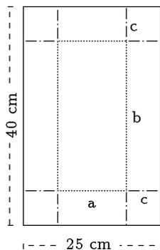
Die Größen  $a$ ,  $b$  und  $c$  hängen alle drei von der Seitenlänge der ausgeschnittenen Quadrate  $ab$ ; bezeichnet man diese Länge der Quadratseiten mit  $x$ , dann ergeben sich für die Länge, Breite und Höhe des gefalteten Kastens (Einheit cm wird weggelassen) folgende Ausdrücke:
