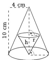
Dieses Volumen  $V$  berechnet sich aus Grundkreisradius  $r$  und Höhe  $h$  nach der Formel  $V = \frac{1}{3} r^2 \pi h$ .
