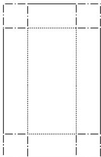
Bei A2 hat der Gegenstand der Aufgabe - der durch Angabe von Länge und Breite gegebene rechteckige Papierbogen - zwei verschiedene Zustände, da er zu einem Kasten gefaltet wird. Das fertige Produkt muss also, wenn schon nicht (wie in der Darstellung links) gezeichnet, so doch zumindest in der Phantasie vorgestellt werden. Zeichnung (oder Vorstellung) machen deutlich: Aus der Seitenlänge des herausgeschnittenen Dreiecks wird die Höhe des fertig gefalteten Kastens.
